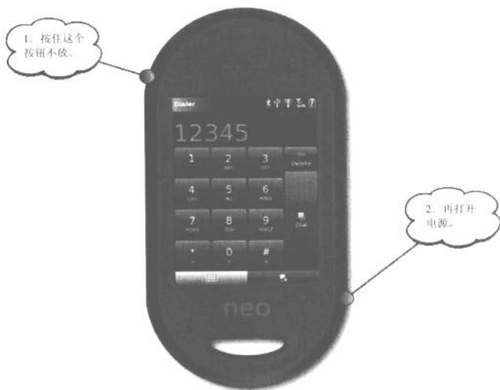
图 17-3 将 Neo FreeRunner 开机到 U-Boot 模式
