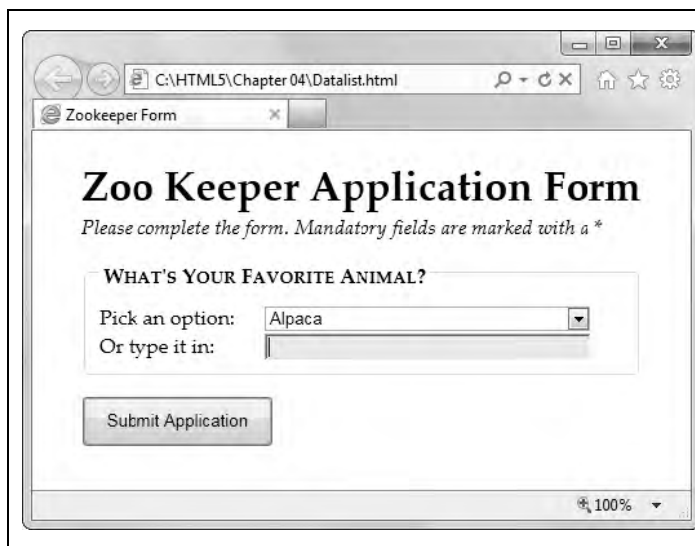
图4-14：在不支持<datalist>的浏览器中也可以使用建议项，但需要把建议项封装在一个<select>列表中
