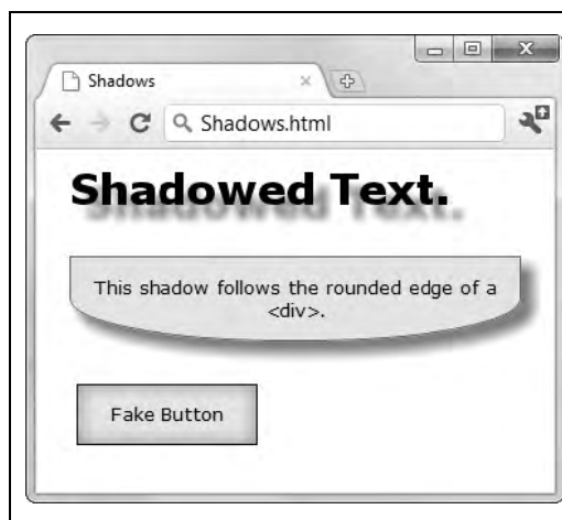
图6-8：阴影可以让文本显得浮起来（上）、让盒子突出显示（中）、让按钮产生发光效果（下）
