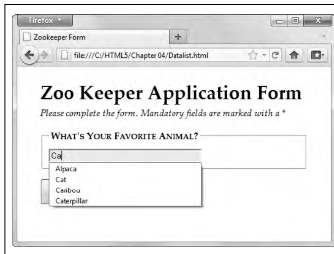
图4-13：输入的同时，浏览器会显示出匹配的建议项。例如，输入字母“ca”，浏览器就会显示名字中包含这两个字母（不一定在开始位置）的动物
