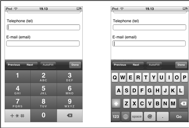
图4-8：在移动浏览器中，要填写表单可没有全键盘可以使用。图中的iPod通过定制虚拟键盘为用户提供了方便，根据要输入的数据类型——电话号码和电子邮件，会分别显示数字键盘（左）和带有@按键及小空格键的字母键盘（右）
