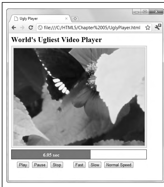
图5-7：制作自己的HTML5视频播放器很简单（要做好可不简单）。这个例子中包含标准的播放控件、播放进度条和其他一些按钮，展示了JavaScript对<video>元素的全方位控制能力
