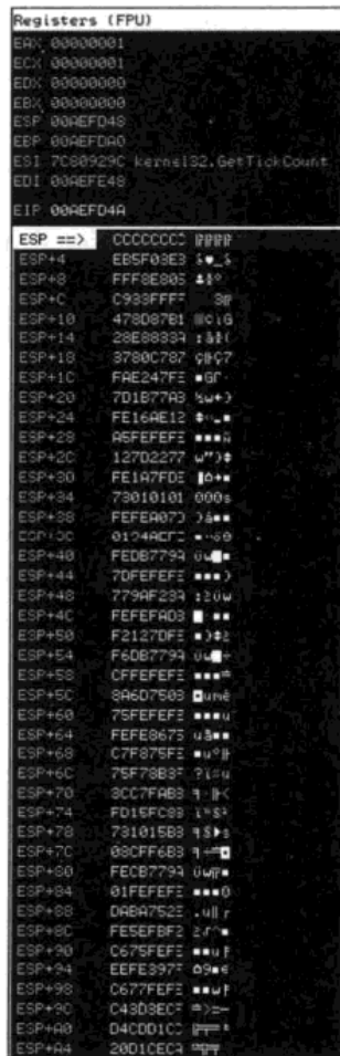
图 5-3 溢出发生后的堆栈窗口
